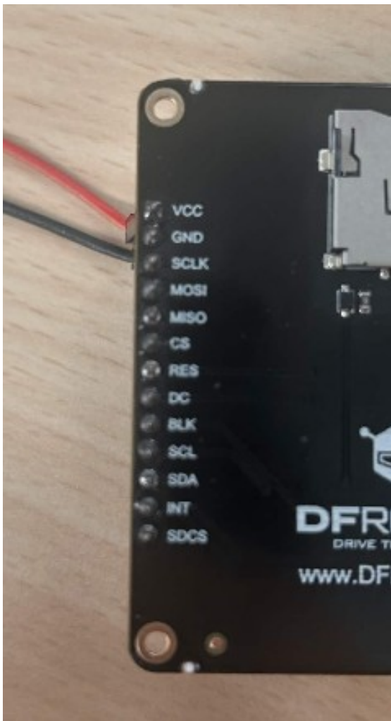
Figure 7 — Face arriere de l'ecran TFT ILI9488 montrant les bornes a maintenir accessibles, contrainte directe pour la piece de support.
